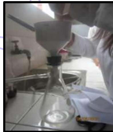
Filtración por bomba al vacío
