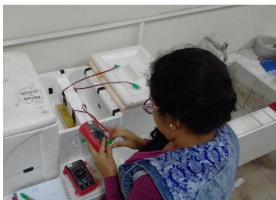
Figura N° 14. Medición de generación de voltaje en las bioceldas, mediante un multímetro.
