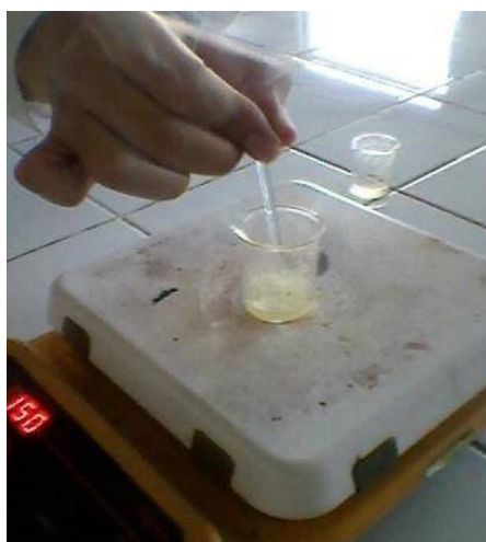
11. Preparación de la muestra de Lactuca sativa antes de realizar la lectura en el espectrofotómetro.
