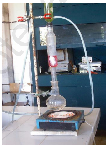
FOTO 9: EXTRACCIÓN EN SOXHLET
